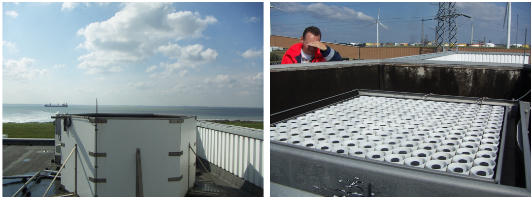
Figuur 2.1: Drie fotos van de SODAR bij de Kerncentrale in Borssele. De bovenste luchtfoto van Google Earth geeft de locatie van de SODAR op het terrein van de Kerncentrale. De foto linksonder laat de SODAR op het dak van het kantoorgebouw zien en de foto rechtsonder toont de luidsprekers/microfoon array van de SODAR.
